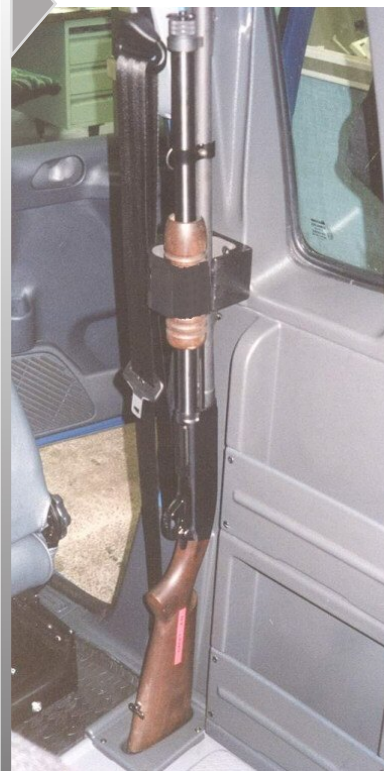
Armero instalado en vehículo
